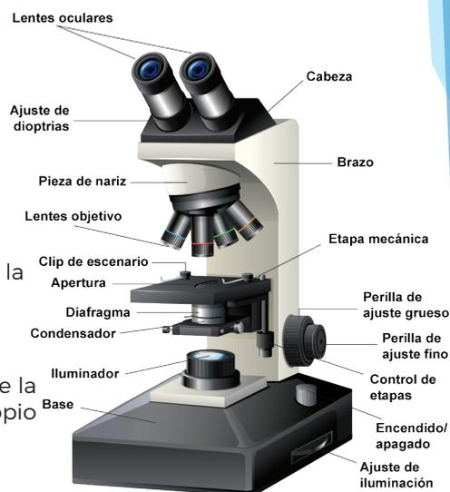
**Figura 1.1.** Partes del microscopio óptico compuesto.
