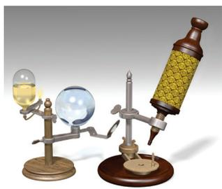
**Figura 1.5.** Robert Hooke creó el primer microscopio compuesto, en el cual se usaban dos sistemas de lentes: oculares, para observar la preparación, y objetivos, para aumentar el tamaño de la imagen.
